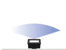
Ohne abgeschrägte Montageplatte
